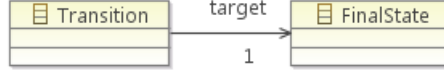
FIGURE 6 – Élément de filtrage pour la comparaison partielle d’un oracle de la mise à plat d’une machine à états
